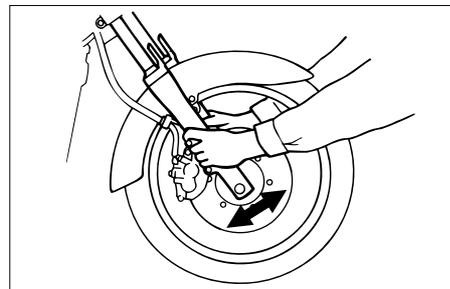
2. Maintenir la base des bras de fourche et essayer de les déplacer vers l'avant et l'arrière. Si un jeu quelconque est ressenti, faire contrôler et, si nécessaire, réparer la direction par un concessionnaire Yamaha.
