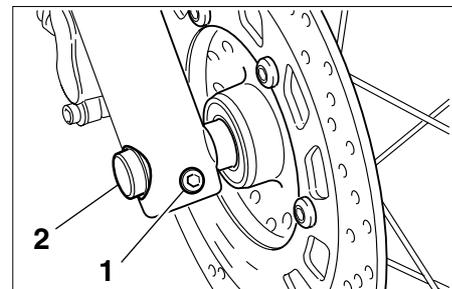
1. Vis de pincement de l'axe de roue avant
