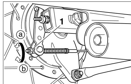
1. Écrou de réglage de la position de la pédale de frein
